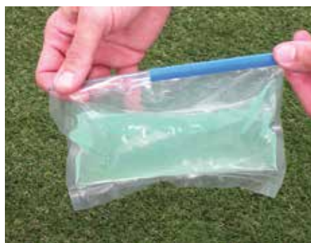
Mescolare i 2 componenti per 30 secondi (sacchetto per GI-BOX, caraffa per GL-BOX)
